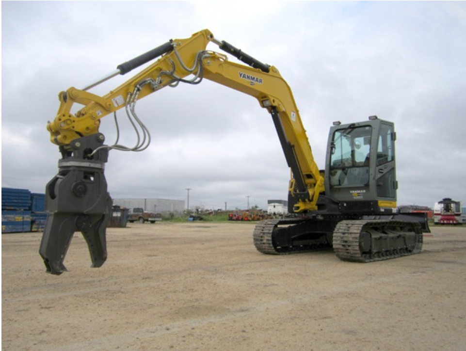
FOTOGRAFÍA 9: RETROEXCAVADORA CON CIZALLA
