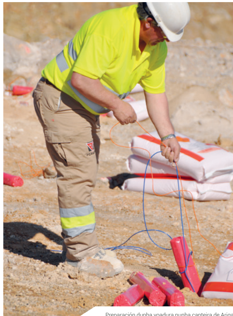
Preparación dunha voadura nunha canteira de Arigal.
